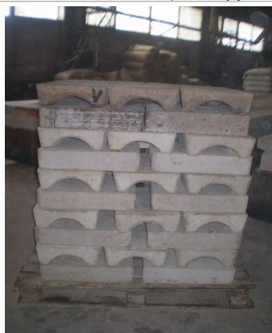
Блоки канализованного пода из жаростойкого бетона на шлакощелочном вяжущем
