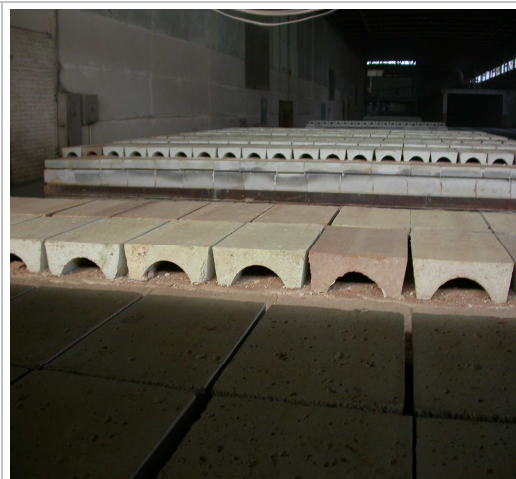
Блоки канализованного пода в футеровке печной вагонетки
